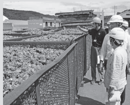
完成したRDFは発火防止のため、屋外に保管していました
