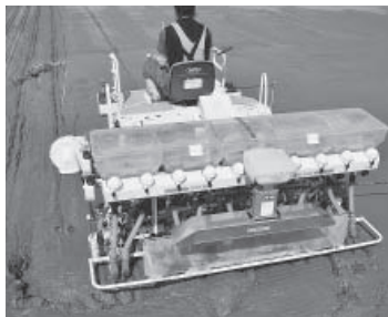
▲播種機。大きさは一般的な田植え機ほどで、溝を切って進むと同時に導管から種もみを落とします。
