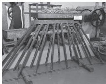
▲町郷土資料館にあるたこ足直播器。上部にある種もみ箱からたこ足状の導管を通して種もみが落ちる仕組み。
