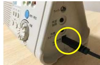
③戸別受信機の向かって右側面の外部電源端子にアダプコードを接続します。**※付属のアダプタ以外は使用しないでください。**
