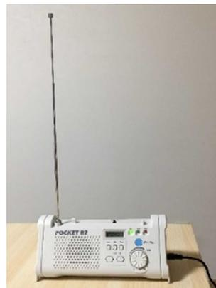
⑥アンテナを真上にいっぱい伸ばして設置完了です。できるだけ窓側に置いてください。
