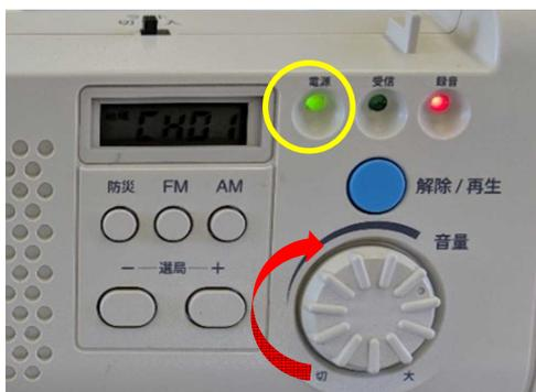
⑤ダイヤルを右に回すと電源が入ります。ダイヤルを回して音量を調節してください。電池残量が少なくなると電源ランプが**赤⇔緑**の点滅に変わります。
