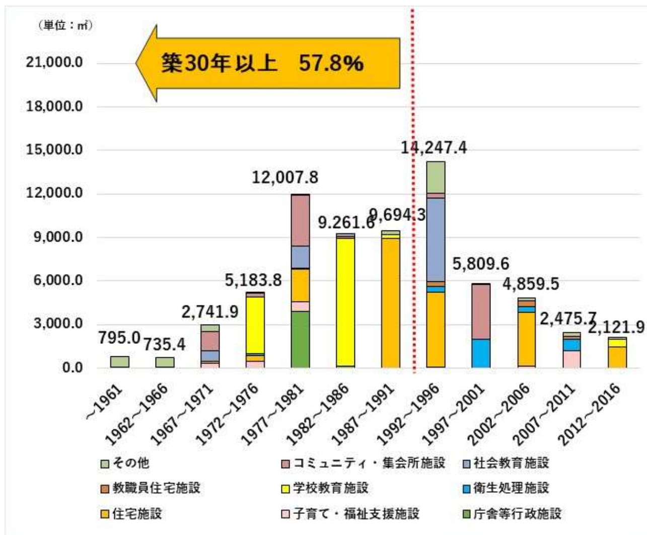
【公共建築物の築年別整備状況】
